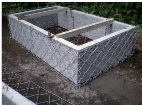
ふとんカゴBOXとは、ふとんかご(網・別売)の内側に設置するポーラスコンクリート製箱型底無形状の製品です。骨材20mm～5mmと鉄筋を使用しており、従来のふとんかごの強度と比較しても十分な強度を有するものであります。
